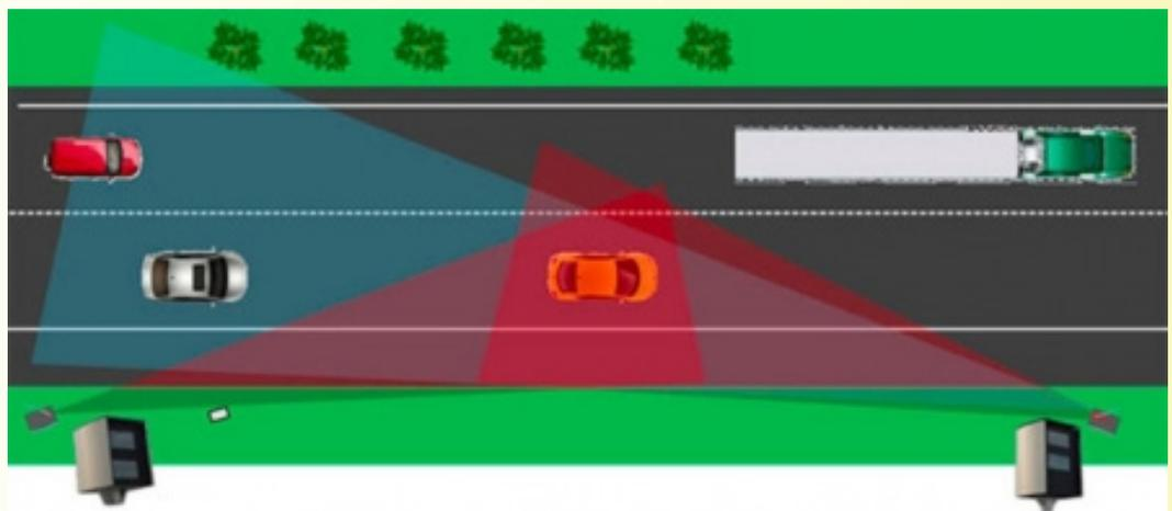
Une photographie de l'arrière du véhicule en infraction est prise par un premier équipement couplé à un deuxième appareil de prise de vue qui est, lui aussi, posé sur un mât. Les deux équipements, distants de quelques dizaines de mètres, prennent leur cliché respectif simultanément.
