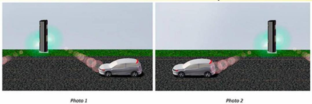
Ce modèle de radar est équipé de deux optiques orientées différemment, mais réunies dans un même équipement. Une première photographie est prise de l'avant du véhicule flashé puis la deuxième optique photographie l'arrière.
