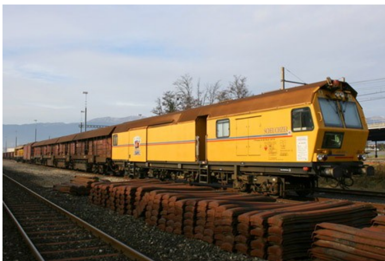
Train meuleur de rails (Scheuchzer S.A.)
