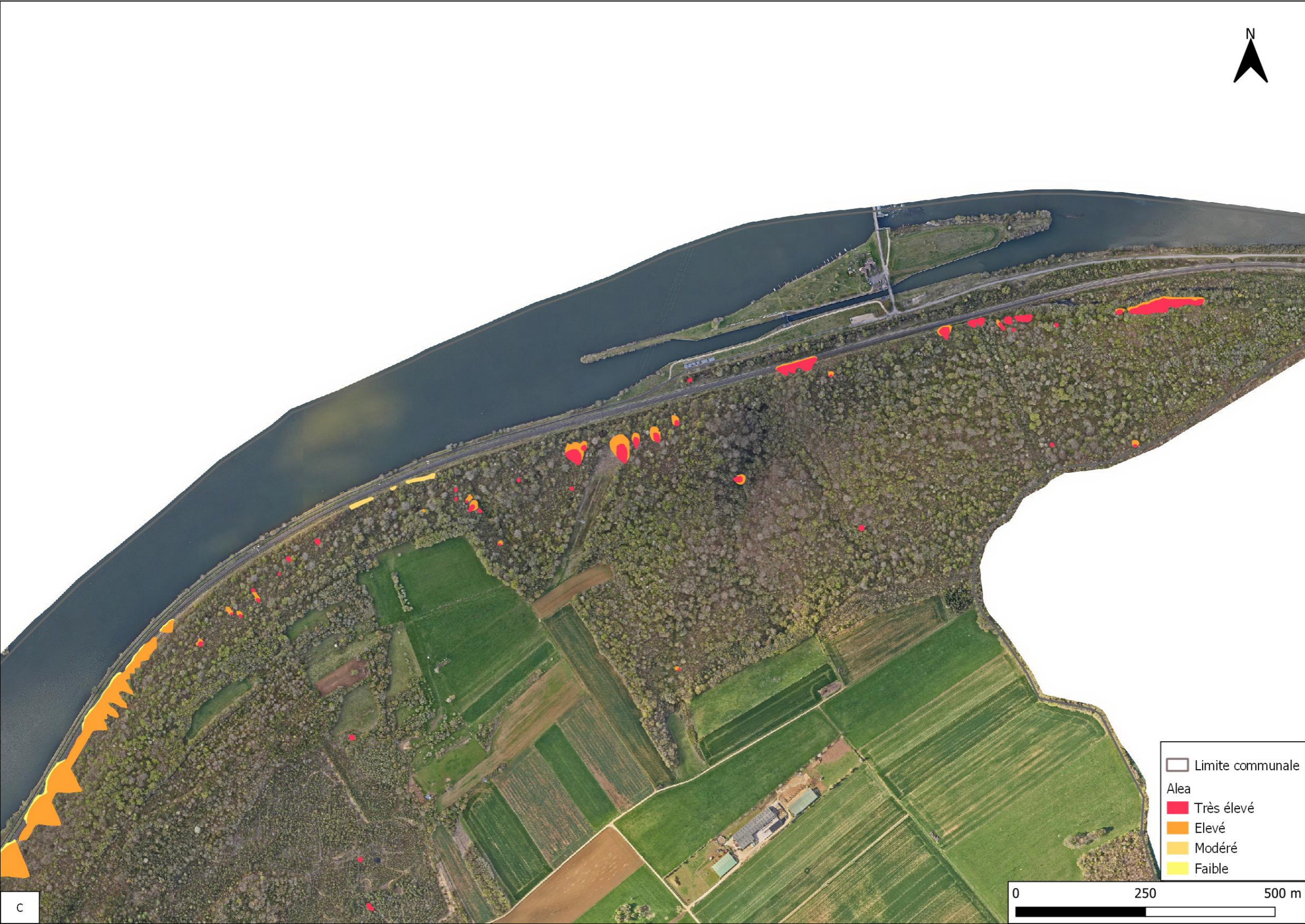
Illustration 75 – Carte de l'aléa chute de blocs "C" (fond orthophotographie, 2019)
